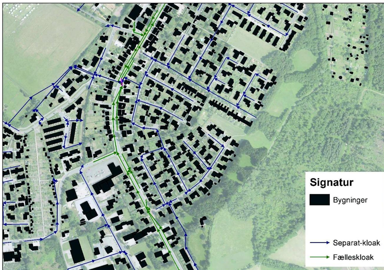
Figur 2 *Oversigt over kloakeringen af Dyrehavekvarteret. Selve Dyrehavekvarteret er separatkloakeret og leder via Ø900 regnvand frem mod Vestre Enge til videre oppumpning til Vestre Enge Landkanal*
